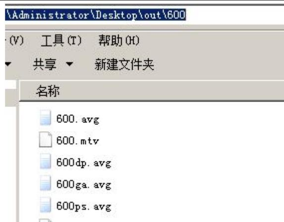
如果您的工程有多个测量点, 请重复以上步骤, 对每个测点使用 MTEdit, 得到 avg 文件。
